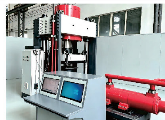
2000吨 电液伺服压剪试验机
