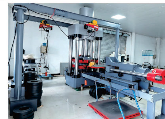
500吨 电液伺服压剪试验机
